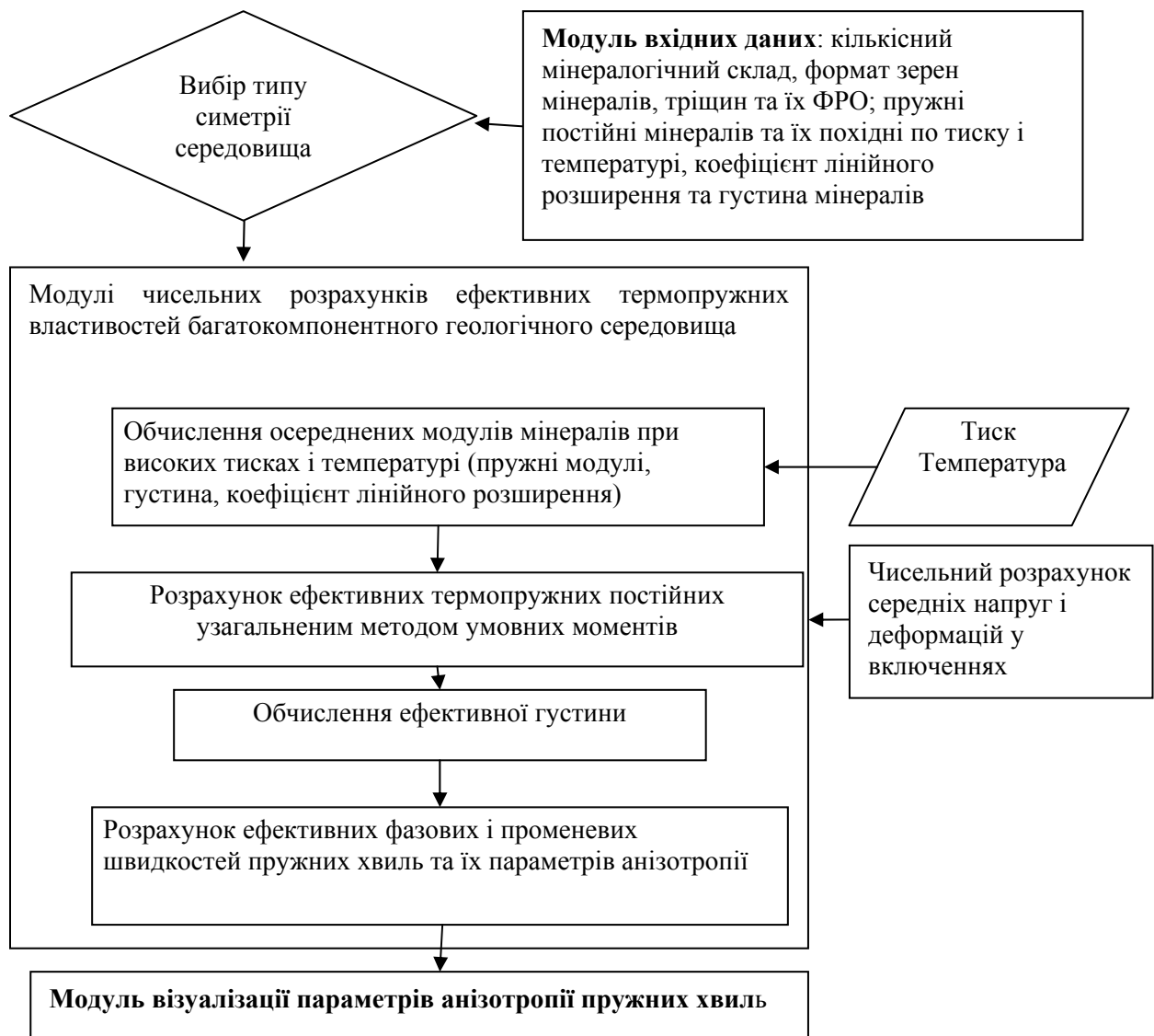
Рисунок 1. Блок-схема чисельних розрахунків ефективних термопружних і акустичних параметрів анізотропного тріщуватого багатокомпонентного геологічного середовища за допомогою узагальненого методу умовних моментів.
