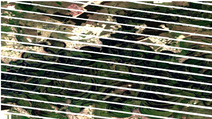
Рис. 1.13. Фрагмент супутникового зображення Landsat 7 з шумом (дефектом) при скануванні поверхні Землі від 23.05.2006 р.
