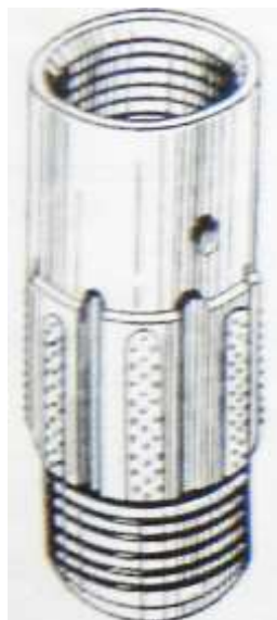
Рис. 2.5. Алмазна коронка типу 01А3, одношарова
